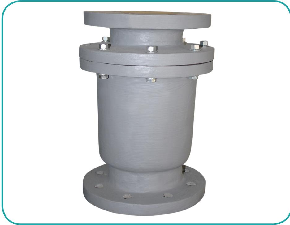
Válvulas de retenção verticais fabricadas em materiais resistentes à corrosão (PRFV, UHMW, PTFE), com tamanhos de 1" a 10" e pressão de operação até 10 BAR. Fechamento por êmbolo cônico. Extremidades flangeadas ou rosqueadas.
