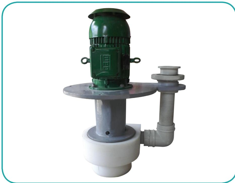
Bombas Centrífugas **Verticais – carcaça submersa**, para serviços gerais ou pesados em condições de corrosão e abrasão, na **configuração monobloco** e sistema de **selagem hidrodinâmica**.
